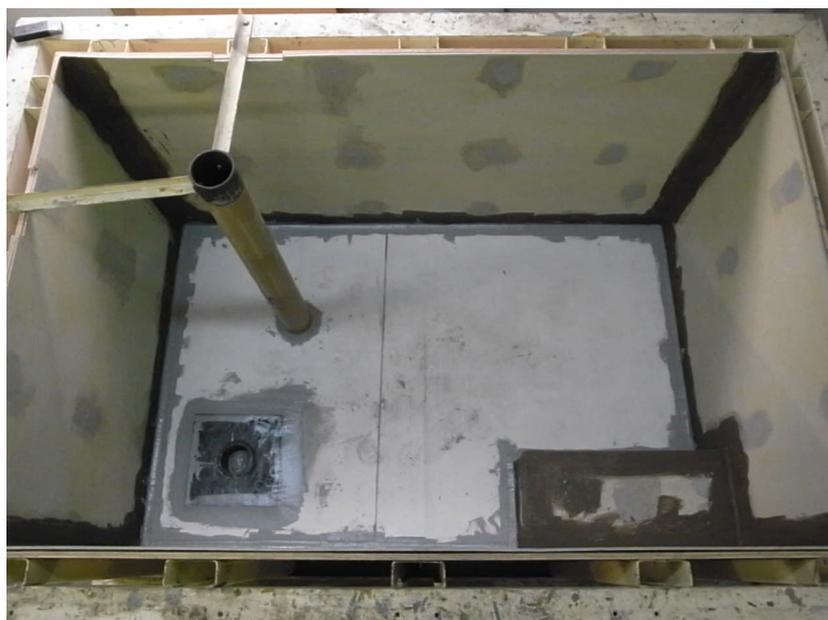
写真1 水密試験用試験体の作製状況
