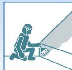
セットバックや壁など、急勾配や段差のある箇所に対応した半フロータイプです。形成された防水層は、柔軟で防水性に優れ、下地の動きにも追従します。
